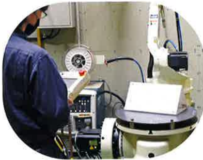
溶接ロボット
