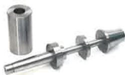
技能試験1級で作成した「アーバ」(右)と「スリーブ」(左)。 いずれの部位も公差0~0.005mm以内が要求されます。
